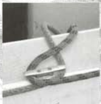
柱間に止まっているロープを解いた後、ロープを持ったまま船に乗り込み、家内て船尾にいない場所に着いておこう。
